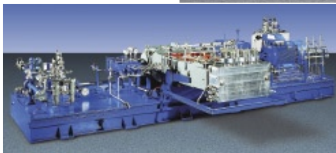
Насос высокого давления для обработки остаточного масла (нефтепродукта) при температуре 300 °C
