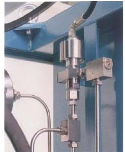
Встроенный разгрузочный вентиль может иметь и внешнее управление.
