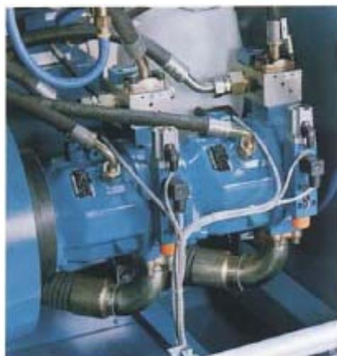
Надежный гидравлический привод с двойным аксиально-поршневым насосом и отдельной системой охлаждения и фильтрации
